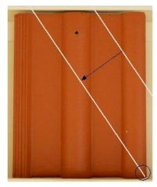
Выполняется дополнительная разметка для черепиц, которые при укладке на скат имеют ширину видимой части менее половины полезной ширины черепицы, т.е. тот случай, когда необходимо устанавливать половинчатые черепицы. Существующая разметка переносится параллельно к нижнему углу черепицы, позволяя получить максимальный размер подрезанной черепицы.
